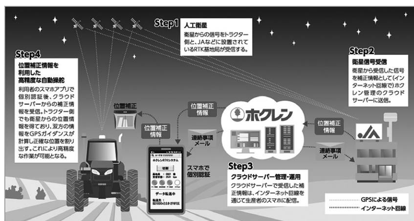
図10 「ホクレンRTKシステム」の流れ
