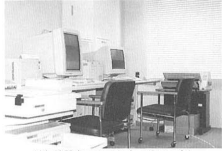
情報機器室 手前が光ディスクファイル 奥がワークステーション
