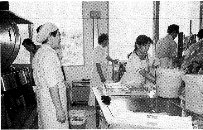
農産加工場の中、トマトジュースのびん詰作業中 左奥の大釜は一度にトマト150kg入ります。
